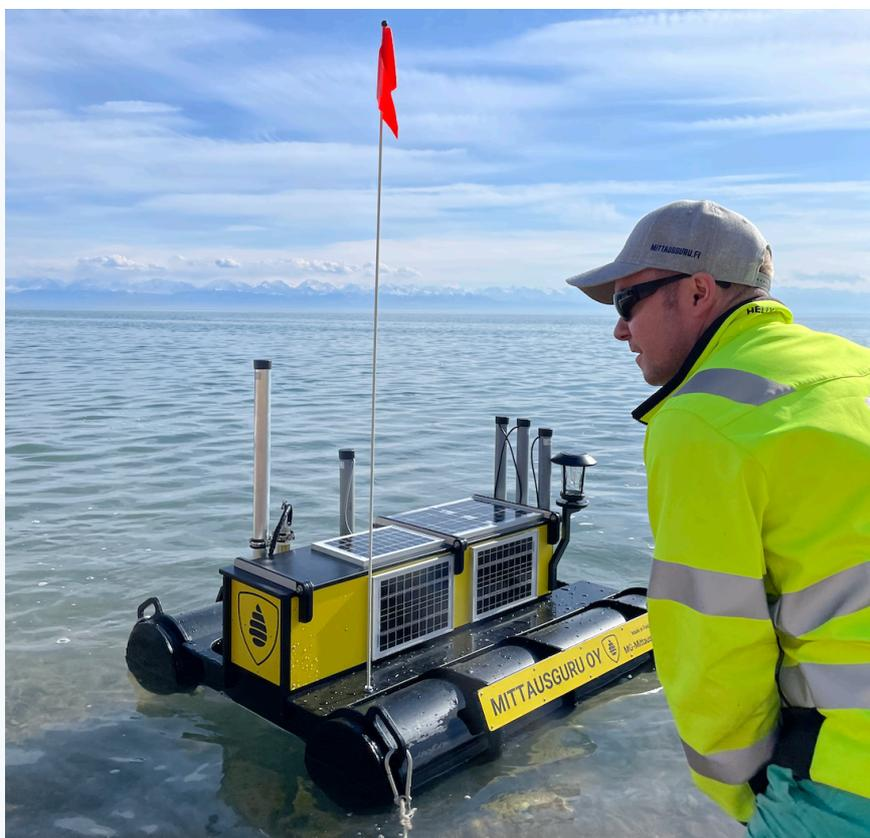
Пример монтажа станции озере Иссык-Куль, март 2024. Станции якорятся в согласованном месте, чаще всего за стоком воды промышленного предприятия или КОС водоканала
